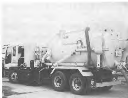
写真-6 がら回収機用特殊吸引車
