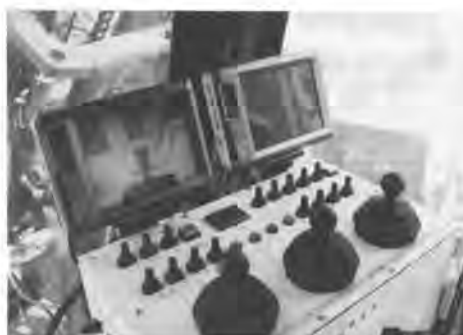
写真-6 モニター付操作ボックス
