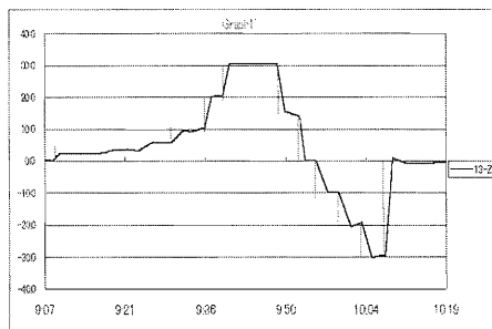
図-11 Hy P o S計測による強制変位応答結果
