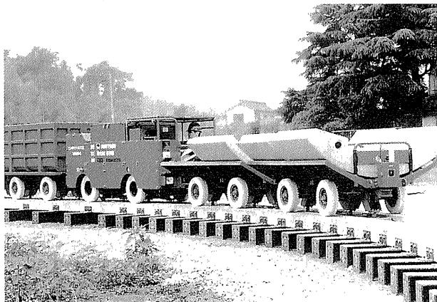
写真-3 タイヤ式坑内搬送システム
