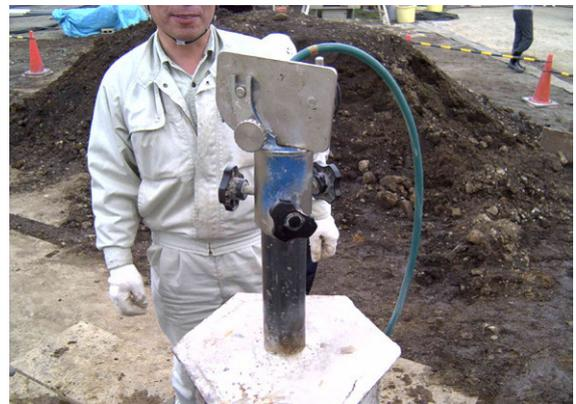
写真-2 挿入式傾斜計による削孔精度確認状況
