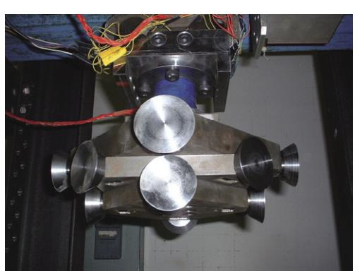
写真-1 深礎掘削機モデル
