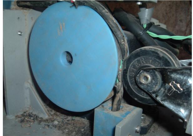
写真4: 台車移動速度と巻取速度の違いによるケーブル損傷状況
