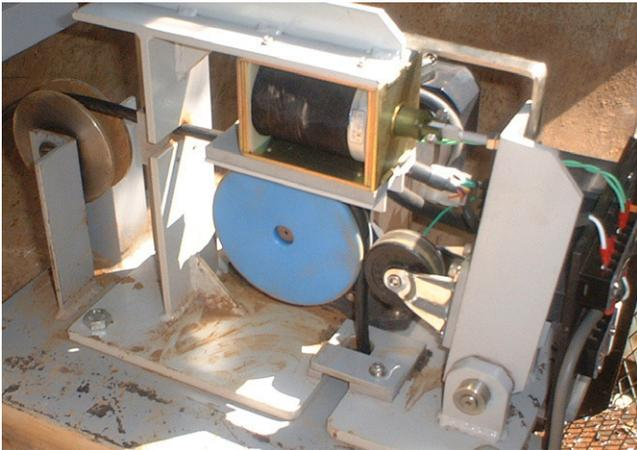
写真1: 巻取り装置設置状況
