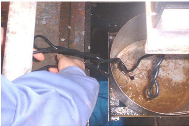
写真2: 丸形ケーブルを使用しヨリが発生している状況
