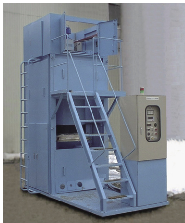
写真 1 テーブルアップ・フィーダの外観
