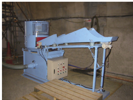
写真4 簡易型補強繊維供給装置「サブフィーダ」
