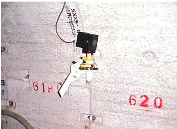
写真 2-1 プリズムによる基準点計測
