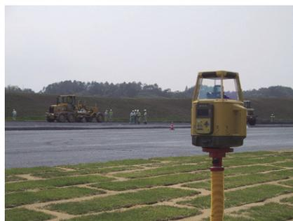
写真-1 回転式レーザ発光器 (Rt-5sa) トプコン社製
