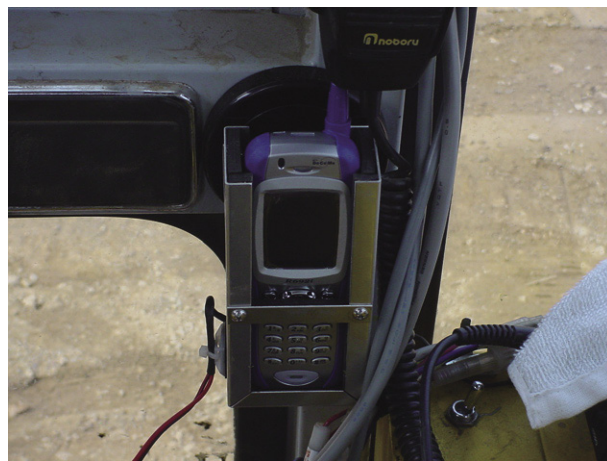
写真－3 ネットワーク型RTKで使用した携帯電話
