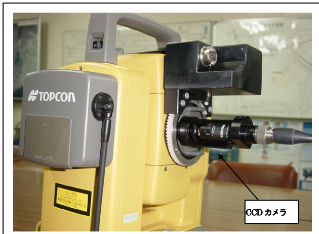
写真-1 CCDカメラおよびピン調整機構取付
