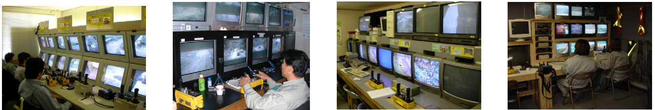
図-4 無人化施工におけるマンマシンインターフェースの事例
