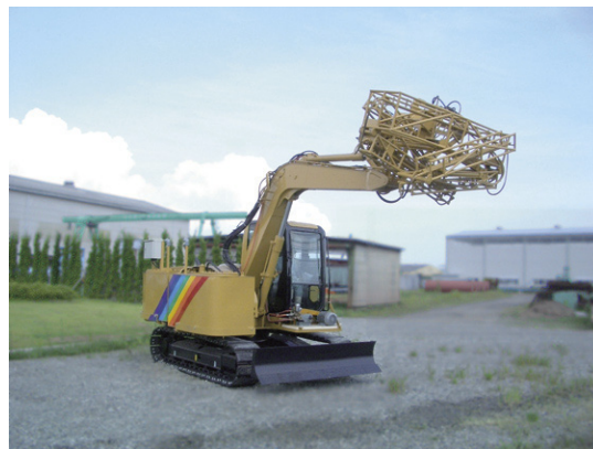
写真2 自走式噴霧養生装置（アーム格納状態）
