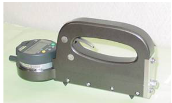
写真6 コンタクトミクロンストレインゲージ
