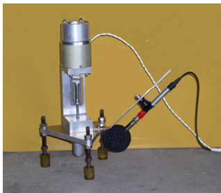
図4 ソレノイド式打撃装置（試作機）
