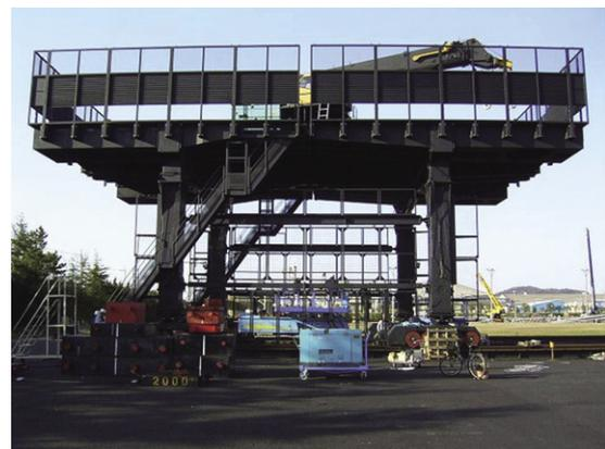
写真-1 杭施工用高架施工機仮組状況(塗装前)
