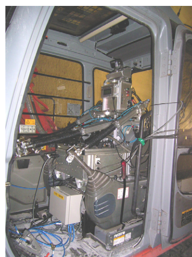
写真-2 ロボQ取付状況
