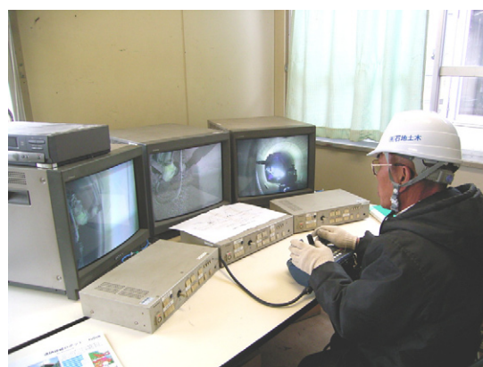
写真—8 コントロールルームから遠隔運転
