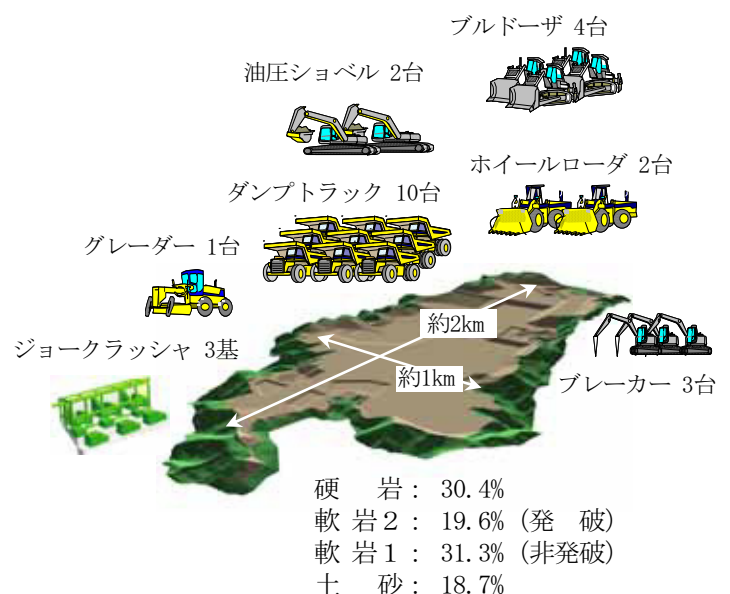
図-3 現場で使用された建設機械と地質区分の概要
