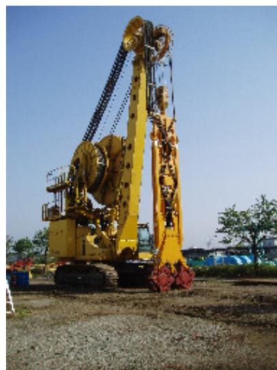
写真-1：吊り下げ型CSM機
