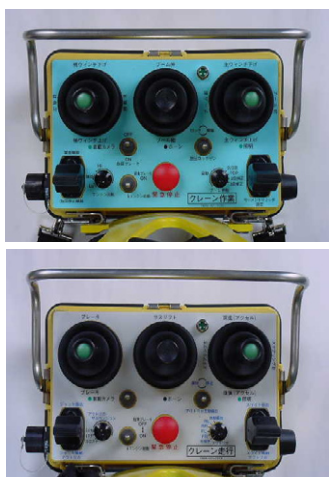
写真4 送信機（上が作業用，下が走行用）
