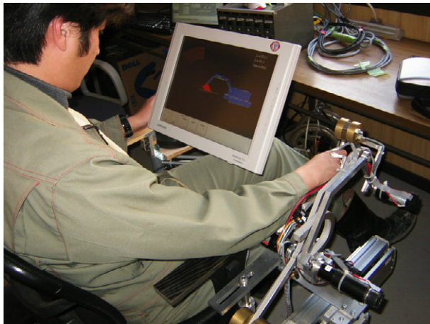
Fig.2 相似形入力装置による遠隔操作
