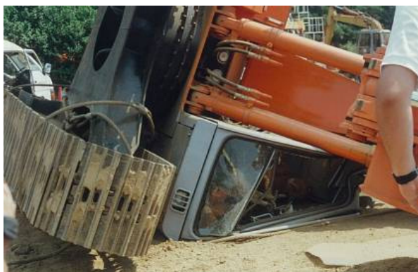
写真4 実機横転試験状況（旧 EX-3 型）
