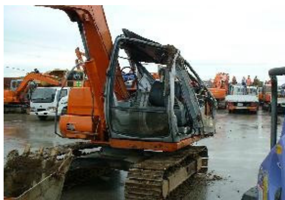
写真2 実機転倒事故状況（旧 EX-5 型）
