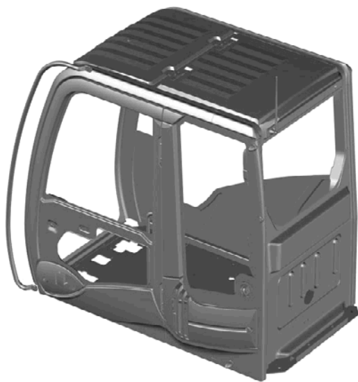
図6 ZX-3 ROPS キャブ構造
