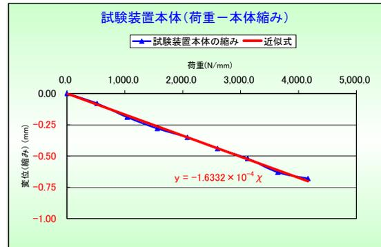
図-6 地耐力試験装置本体の縮み
