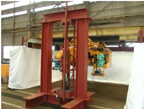
写真－1 遠隔操作による地耐力試験状況
