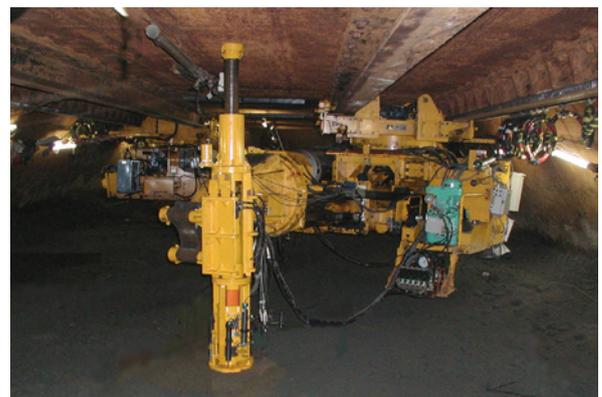
図-10 遠隔操作による地耐力試験状況
