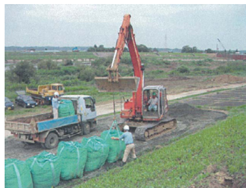
写真-1 クレーン仕様バックホウ
