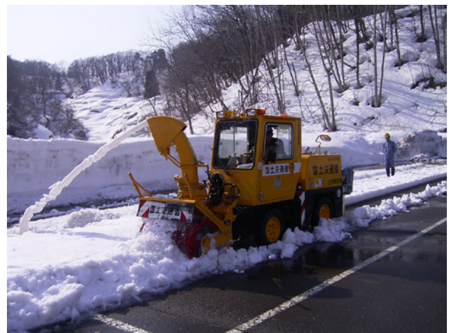
写真-2 雪詰まり防止機構の試験状況
