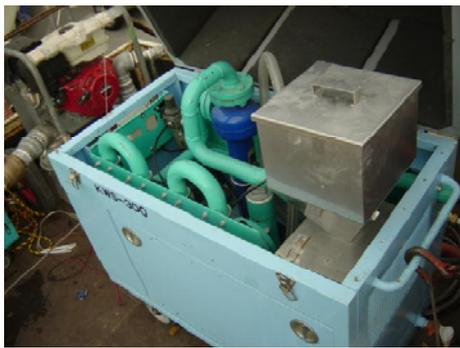
写真-3 液体サイクロン式浄化装置
