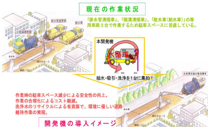
図-2 清掃作業の現状と新型清掃車導入イメージ
