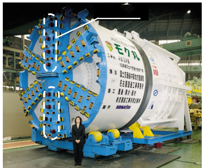
写真-1 φ4,800mm 春日井共同溝シールド機
