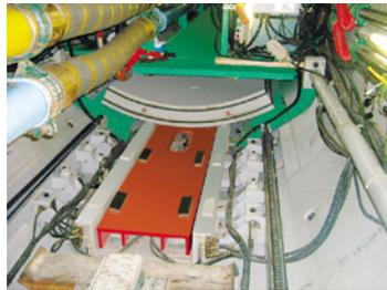
写真-10 リフトアップ台車 写真-11 セグメント搬送装置
