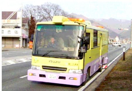
図-1 新型路面下空洞調査車による一次調査
