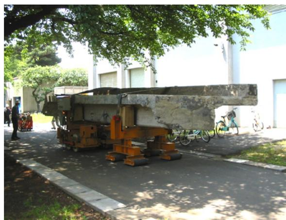
写真-1 重量物運搬台車による運搬
