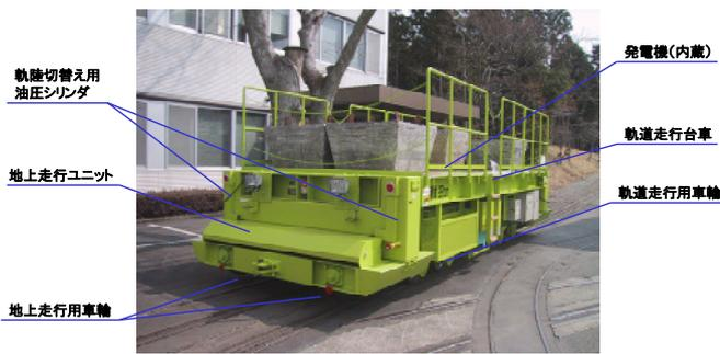
図-4 軌陸式重量物運搬台車
