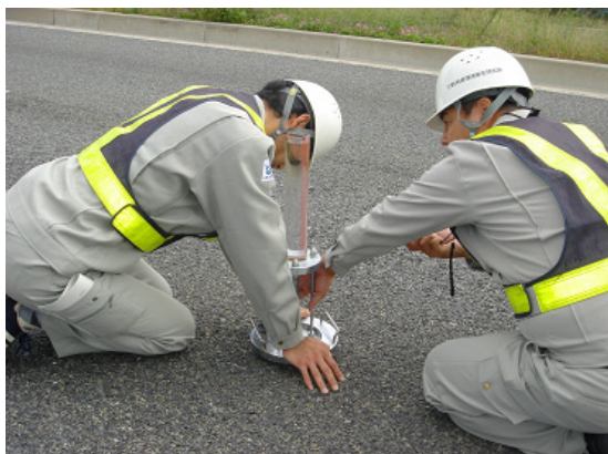
写真-2 現場透水量の測定
