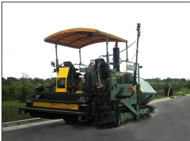
写真2 高精度 GPS-3D-MC フィニッシャ
