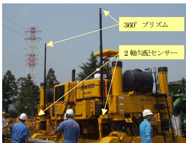
写真-2 センサー取付状況
