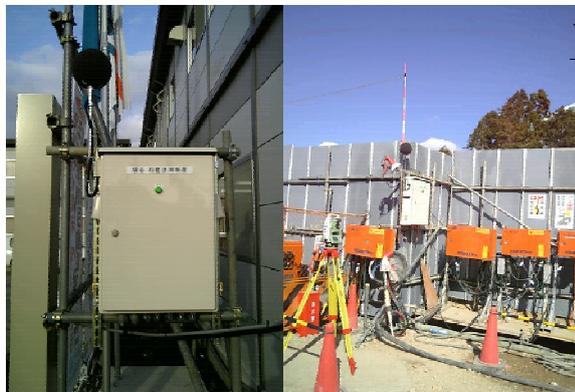
写真5 騒音・振動計、粉塵計測盤
