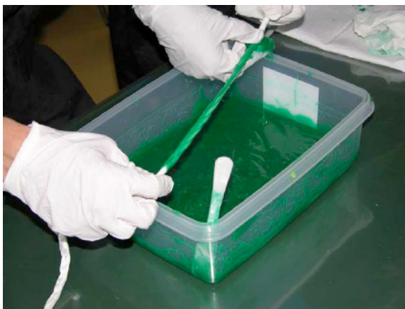
図4 エポキシ樹脂の含浸作業状況
