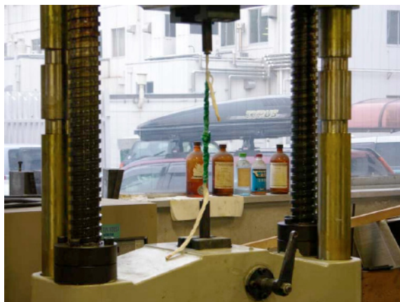
図10 接続部の引張試験状況
