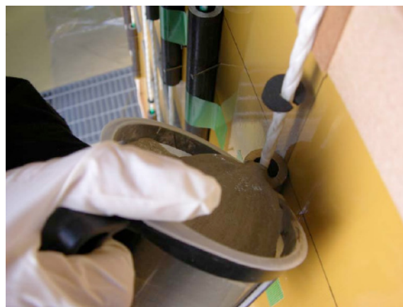
図6 定着用膨張材の充填状況
