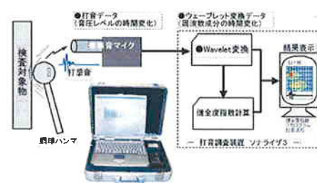
図6 打音調査原理(ウェーブレット法)
