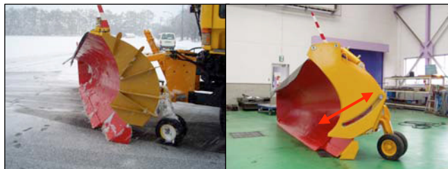
写真6 最適なデフレクタ形状(左)と試作機(右)
