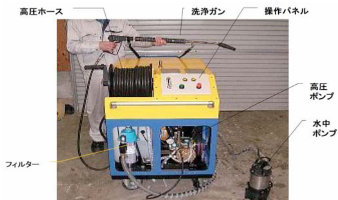
写真-2 簡易橋梁洗浄装置前面
