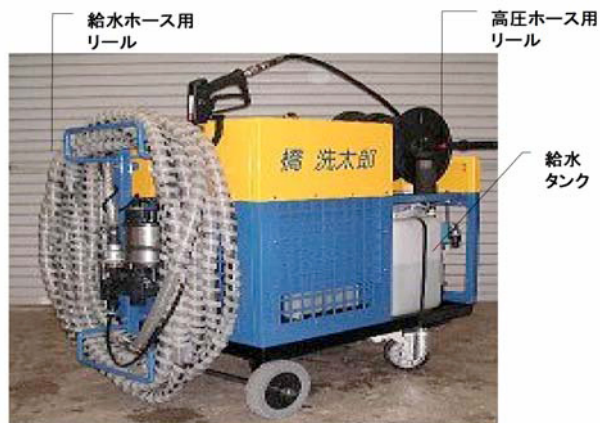
写真-3 簡易橋梁洗浄装置側面
