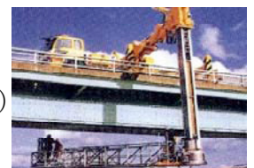
写真-9 橋梁点検車の例
