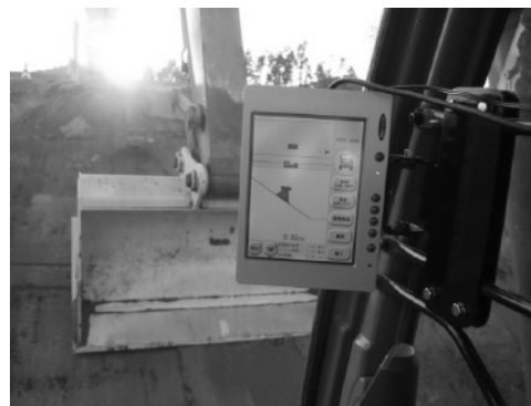
図9 オペレータから見た表示画面
