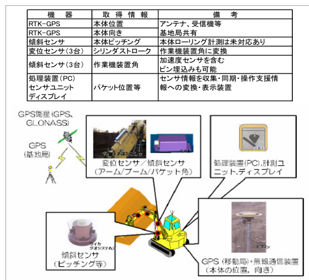
図－1 情報化施工システム技術 (バックホウシステムと機能)
