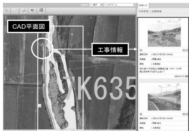
図-5 CAD 平面図との重ね合わせ
