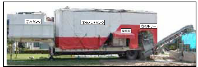
写真-1 湿潤セメント製造装置外観
