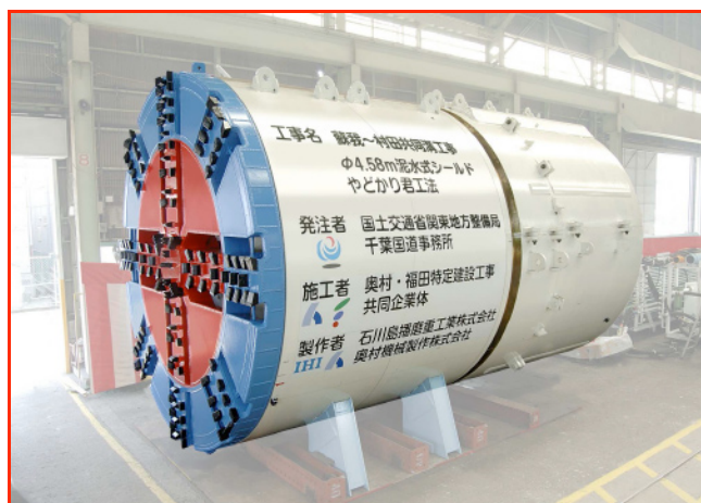
写真－４ シールド機全景
