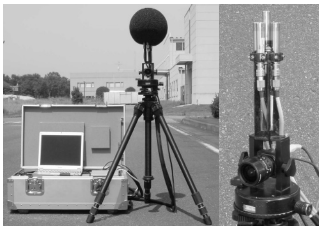
写真1 音源探査システム概観およびセンサ部
