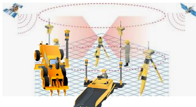
図-5 mmGPSシステムイメージ図
