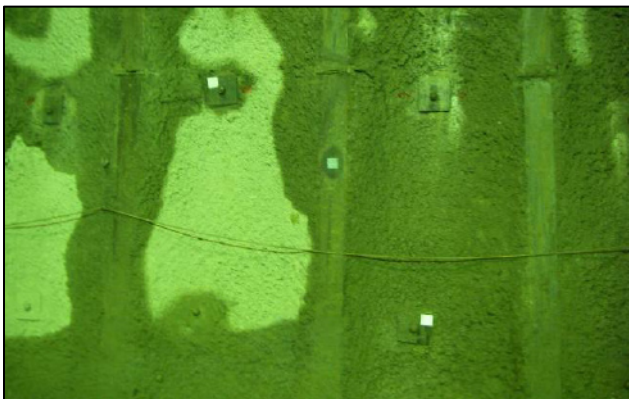
写真－3 画像合成・測量用反射ターゲット
