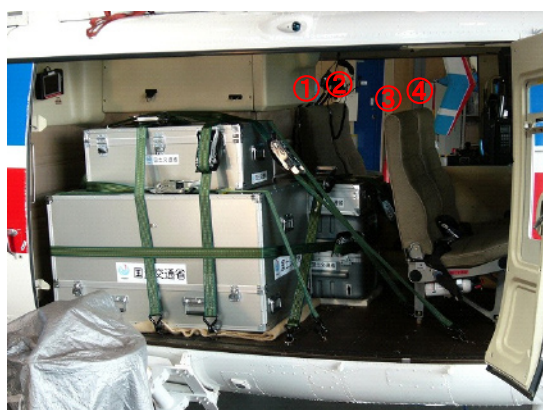
写真-6 ユニットの固縛状況
