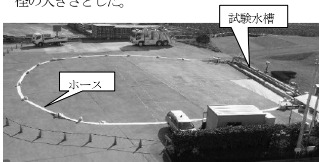
写真-1 摩擦損失実験施設の配置状況
