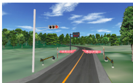
(e) 警報表示板と遮断機（山岳部）
