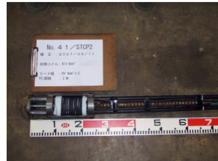
写真-7 鋼製第1耐荷体
