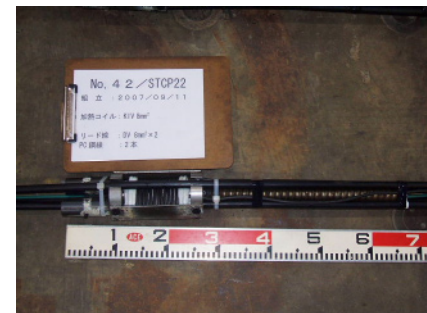
写真-8 鋼製第2耐荷体
